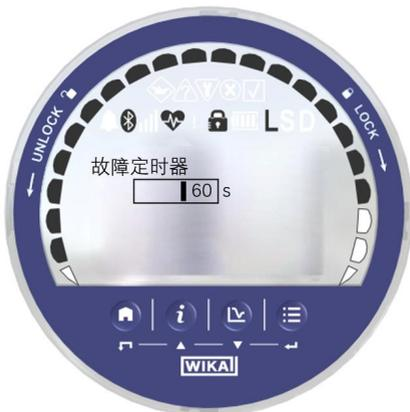
图6-35 故障定时器编辑界面
