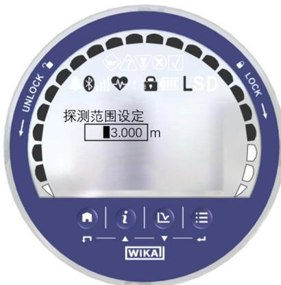
图6-22 探测范围设定编辑界面
