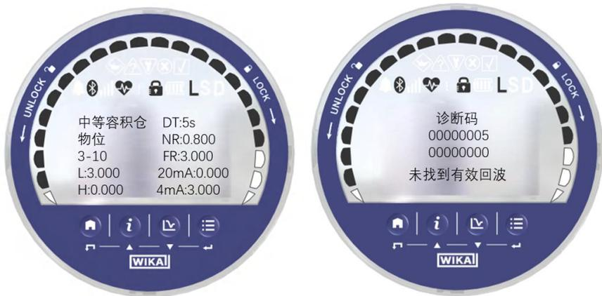
图6-11 参数速览界面示意图
