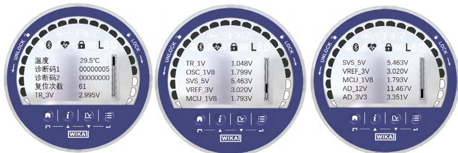
图6-39 设备状态显示界面
