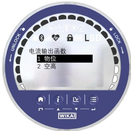
图6-30 电流输出函数编辑界面
