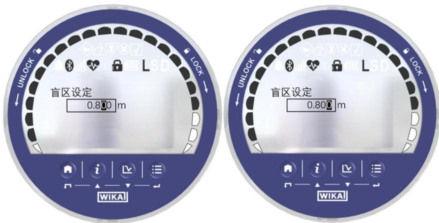
图6-14 【回波（向下）】键实现光标右移
