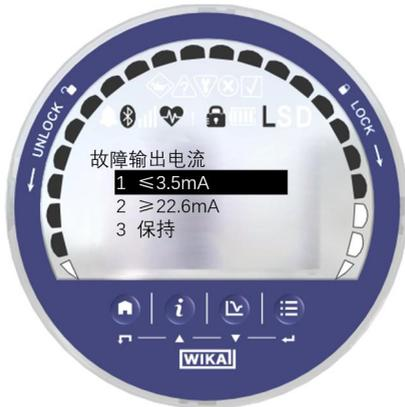
图6-34 故障输出电流编辑界面
